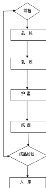
图1 皱纹铜管外导体射频同轴电缆（馈线）产品生产工艺流程图
